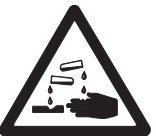
Riesgo de corrosión
